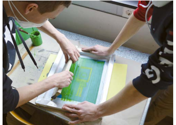
Durchdrücken der Siebdruckfarbe mit dem Raket
